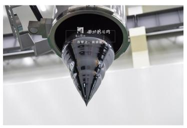
这根硅单晶棒长约 1.5 米、晶体重达 270 公斤,可切割成 1500 多片硅片。在我国集成电路 用硅片绝大部分依赖进口的情况下,金瑞泓每月 15 万片硅片的量产规模将有效替代进口, 推动我国集成电路产业加快发展。
